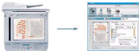
Der SCX-5530FN ist ausgestattet mit spezieller OCR-Software (Optical Character Recognition), die das Abtippen von Texten überflüssig macht. Scannen Sie einfach ein Textdokument ein und OCR transformiert die Wörter in editierbare Zeichensätze. Anstatt Zeit für das Abtippen zu verwenden, können Sie die Texte jetzt einfach bearbeiten.
